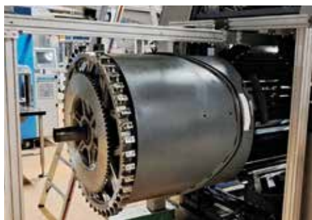
Die Steuertrummel ist eine Schlüsselkomponente der MSD-Einstecktrummel und wurde nach einer beachtlichen Lebensdauer von über 20 Jahren von der Ferag AG ausgetauscht.
