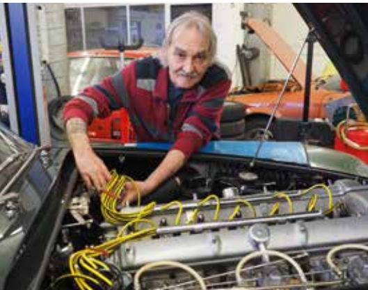
Jenő Csikos am Montieren der gelben Zündkabel
